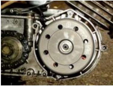
Bild zeigt Motor ohne Lüfter
