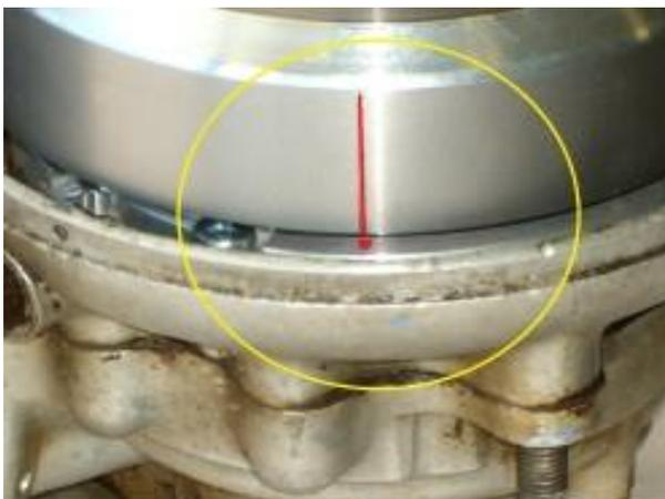
Entfernen Sie die Zündkerze und bringen Sie den Kolben durch Drehen des Rotors in Zündposition (siehe Handbuch des Sachs 98, wenn nicht vorhanden versuchen sie es mit 5mm vor OT). Bei Sachs Motoren mit 74ccm benutzen sie bitte, laut Handbuch 7mm vor OT
