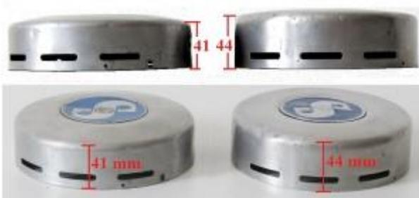
In einigen Fällen kann es vorkommen, dass die Abdeckung ein wenig auf dem Rotor schleift.
