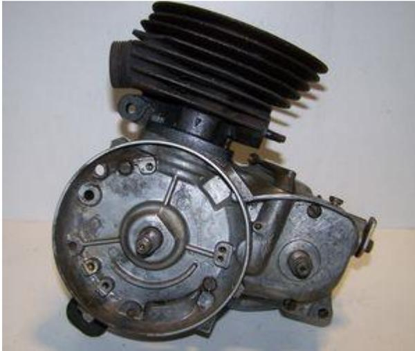
Entfernen sie die originale Lichtmaschine/Zündung.
