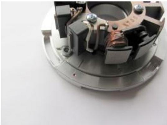
Bitte beachten Sie die kleine (rote) Markierung der Stator-Grundplatte zwischen den beide eingesenkten Befestigungslöchern.
