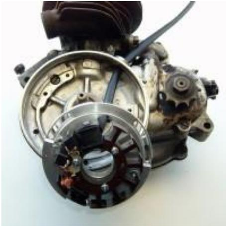
Anschließend führen Sie das Statorkabel durch die Kabelöffnung am Motor.
