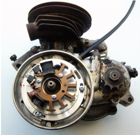
Verschrauben Sie den Adapter mit den 3 Schrauben M5 sorgfältig (so wie im Bild gezeigt).
