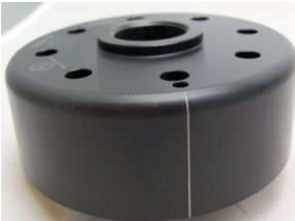
Sehen Sie sich den Rotor an, auf seinem Außenumfang finden Sie eine kleine Markierung (gekerbte Linie). Hier auf dem Bild zur besseren Erkennbarkeit weiß hervorgehoben.
