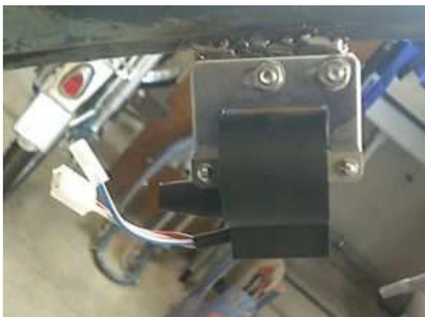
Leider ist bei dieser Anlage die Zündspule nicht mehr auf der Lichtmaschine integriert und muss außerhalb des Motors untergebracht werden.
