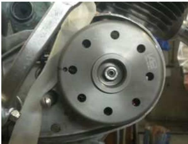
Ziehen Sie den Rotor vorsichtig wieder ab und stecken ihn dann so auf die Kurbelwelle, dass die Markierung auf dem Umfang genau an der Markierung der Grundplatte steht. Drücken Sie den Rotor fest auf die Welle und verschrauben Sie ihn dort mit der originalen Haltemutter.
