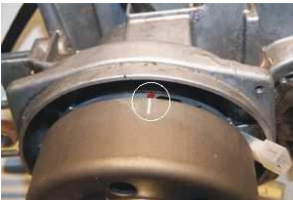
Entfernen Sie die Zündkerze und bringen Sie den Kolben in Zündzeitpunktstellung.
