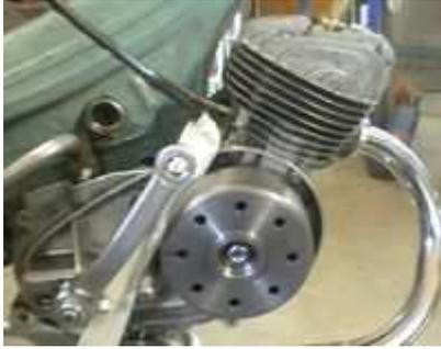
Lichtmagnetzündanlage mit integrierter vollelektronischer Zündung, Lichtleistung bei [6V/18W Wechselstrom \(benötigt keinen Regler\)](#). Kontaktlose wartungsfreie elektronische Zündung. Das System führt nur Wechselstrom und ist daher nicht auf die Ladung einer Batterie und/oder den Betrieb von Blinkern ausgelegt.
