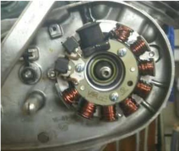
Setzen Sie die Grundplatte mit der lose daran hängenden Statorspule auf den Motor.
