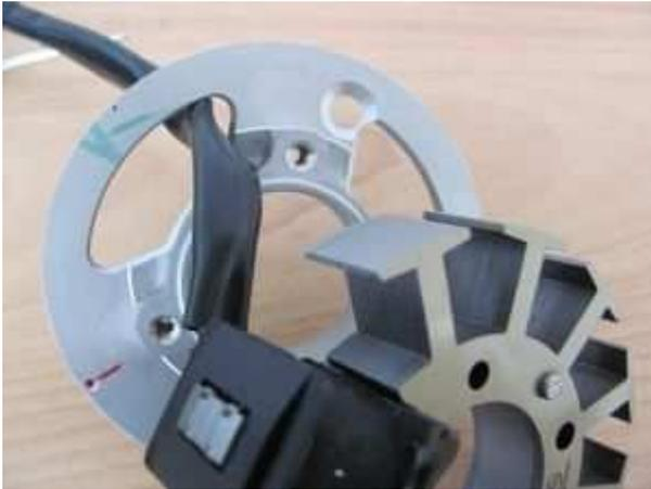
Die Einheit vormontiert. Zur Befestigung der Grundplatte am Motorblock muss die Spule aber etwas angehoben werden (um an die Schrauben darunter zu gelangen).
