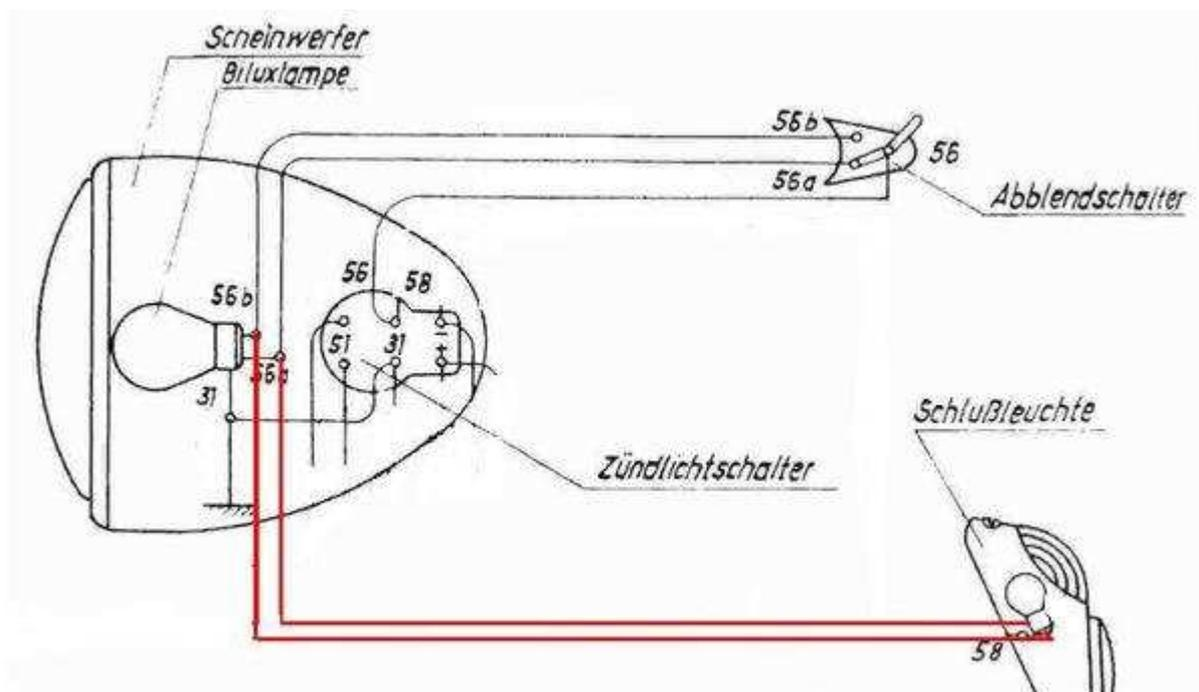
Was Sie tun müssen ist (nachdem Sie geprüft haben ob Ihr Motorrad eventuell schon eine solche Sicherheitsschaltung hat) die Masseverbindung der Rücklichtbirne zu lösen und dort anstelle dieser Masseverbindung ein zusätzliches Kabel zum Scheinwerfer zu ziehen. Sie haben damit nun 2 Kabel vom Rücklicht.
