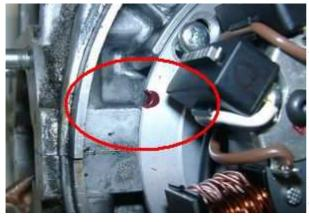
Da die Zündmarke auf der Grundplatte nach Aufsetzen des Rotors leider nicht mehr sichtbar ist, müssen Sie die Markierung entweder auf den Motorblock verlängern oder sich eine markante Stelle am Block merken, die über den Rotor hinaus sichtbar bleibt.
