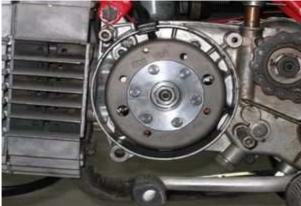
Ziehen Sie den Rotor vorsichtig wieder ab und stecken ihn dann so auf die Kurbelwelle, dass die Markierung auf dem Umfang genau an der Markierung der Grundplatte steht. Drücken Sie den Rotor fest auf die Welle und verschrauben Sie ihn dort mit der originalen Haltemutter. Zum erneuten Lösen des Rotors verwenden Sie einen Abzieher M27x1,25.
