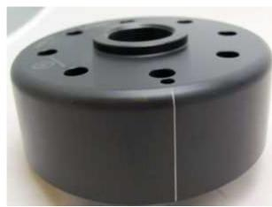
Sehen Sie sich den Rotor an, auf seinem Außenumfang finden Sie eine kleine Markierung (gekerbte Linie). Hier auf dem Bild zur besseren Erkennbarkeit weiß hervorgehoben.
