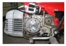
Lichtmaschine/elektronische Zündung für Kreidler K53, alle K54, Flory MF12/13, MF22, MF23, MF24, MF30, **MF34**
