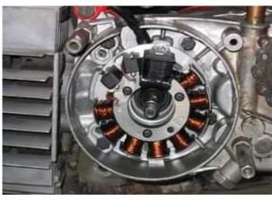
Setzen Sie die Grundplatte mit der lose daran hängenden Statorspule auf den Motor.
