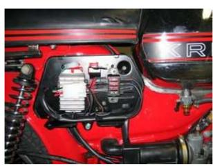
Befestigen Sie den neuen elektronischern Gleichrichter/Regler an einer geeigneten Stelle, z.B. unter dem Sitz oder den Seitenverkleidungen.
