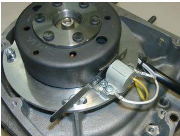
Bleibt noch den Luftspalt zwischen Geberplättchen und Geber einzustellen. Dieser sollte 0,4-0,5mm betragen. Er kann eingestellt werden, indem der Sensor gelockert und etwas verschoben wird.
