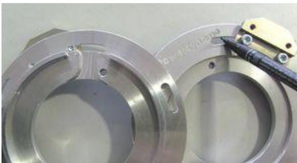
Info: Neben den 3 Langlöchern für die Befestigung hat diese PLatte ein 4. Langloch. Dies dient zum Anzeichnen der Stelle an der das Gehäuse geöffnet werden soll damit am Ende die beiden Öffnungen (jenes in der neuen Grundplatte und jenes welches Sie am Motor machen) auch deckungsgleich sind.
