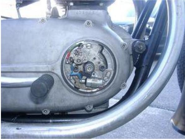
Die Unterbrecherteile auf der rechten Motorseite können entfernt werden oder wirkungslos verbleiben (nur Kabel abklemmen).
