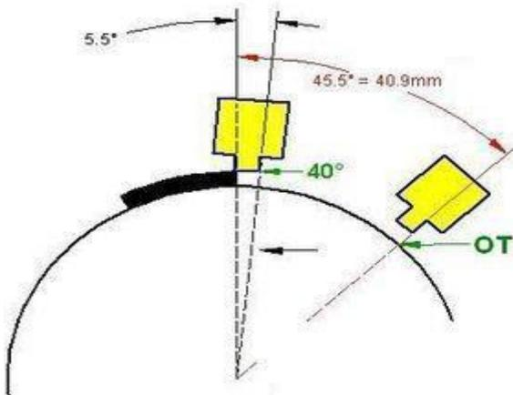
Bei (prüfen!) in OT stehender Kurbelwelle setzen Sie jetzt den Rotor so auf das die rechte Kante des Sensors an der oben genannten Strichmarkierung des Rotors steht.
