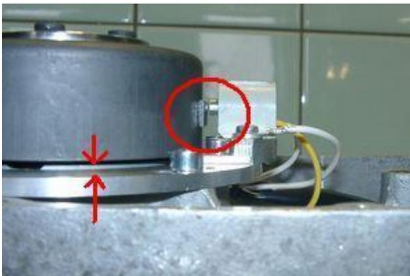
Setzen Sie den Rotor (zunächst lose) auf die Welle und prüfen Sie durch vorsichtiges Drehen per Hand, daß sich der Rotor frei über Platte und Spulenpaket drehen kann. Bitte sehr sorgfältig prüfen, da der Rotor wegen des flachen Deckels der Horex zwangsläufig recht tief ausgelegt ist. Abweichungen an der Welle infolge Regenerierung oder Montage können hier zusätzlich zu Komplikationen führen. Wenn Sie soetwas feststellen - **reden Sie mit uns!**
