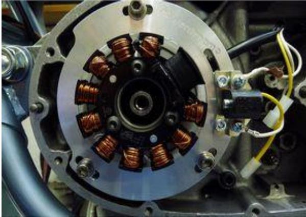
Nehmen Sie die vormontierte neue Statorplatte und setzen Sie diese auf den Motor.
