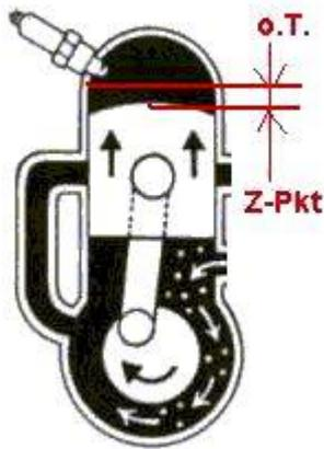
Entfernen Sie die Zündkerzen. Stecken Sie den neuen Rotor handfest auf die Kurbelwelle um die Gelegenheit zu haben die Welle damit zu drehen. Bringen Sie einen (gleich welchen) Kolben zunächst in den oberen Totpunkt (das ist der Punkt, in dem der Kolben seine höchste Position erreicht).
