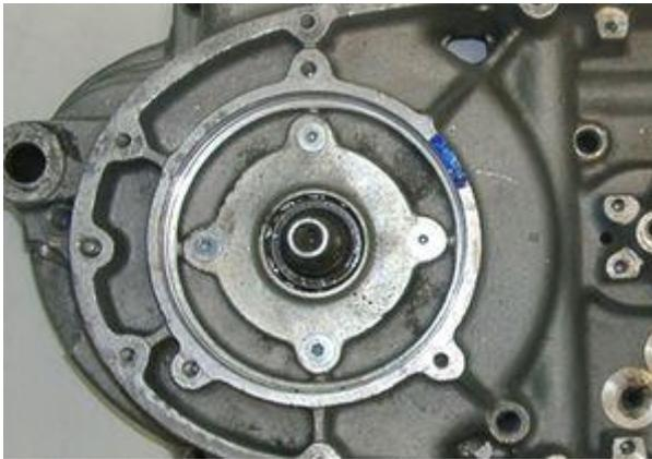
Nun kommt die einzige Stelle, an der Sie Ihrer Horex leider etwas weh tun müssen. Zur Herausführung des unter dem neuen Stator abgehenden Kabels muss eine kleine, ca. 10mm breite Nut (an die links im Bild blau gekennzeichnete Stelle) eingebracht werden.
