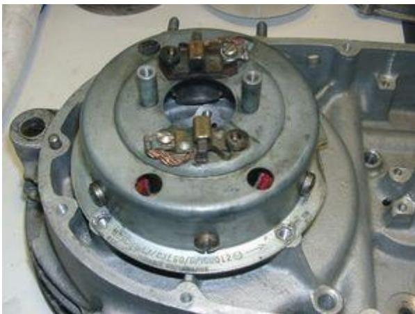
Lösen Sie alle Kabel an Ihrer alten Lima und entfernen Sie diese. Nehmen Sie die Passfeder auf dem Konus der Kurbelwelle mit einer Zange ab. Sie wird nicht mehr benötigt! Bitte nicht vergessen, sonst müssen Sie die Lima später noch einmal herausnehmen. Keine Angst, die entfernte Passfeder hatte nicht die Aufgabe den Rotor zu sichern, sondern nur zu verhindern, dass er falsch angesteckt wird.
