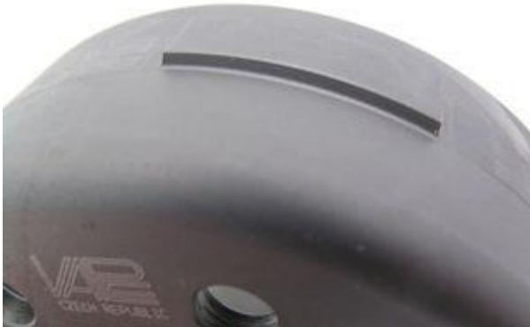
Sehen Sie sich den neuen Rotor an. Sie werden auf seinem Außenumfang ein erhabenes Zeichen finden. Dieses dient der Impulsgebung. Da das System die Frühzündung in Abhängigkeit von der Drehzahl berechnet und diese Berechnung auf der Zeit basiert, die das Zeichen zum Vorbeigang am Sensor benötigt, liegt der Zündzeitpunkt stets nach kompletten Durchgang des Zeichens am Sensor.
