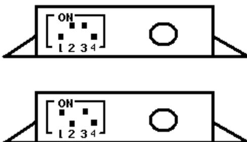
Bei der empfohlenen Kurve müssen Schalter 2/3 auf ON, die beiden anderen entgegengesetzt weisen. Hier erfolgt eine Erreichung der max. Frühzündung bei 3.000U/min.
