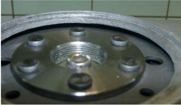
Setzen Sie jetzt den Motordeckel auf und überprüfen Sie, daß der Rotor nicht innen am Deckel schleift. Es geht dort leider recht knapp zu.
