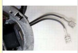
Die beiden schwarzen aus der Lichtmaschine kommenden Kabel führen die Spannung für Licht, Hupe, Blinker usw. Sie haben, wie der Regler überhaupt, nichts mit der Zündung zu tun.
