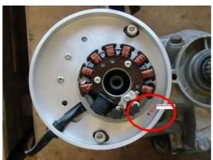
Sehen Sie sich die neue Grundplatte der Lima an. Hier finden Sie (im montierten Zustand bei etwa 4 Uhr) eine rote Punktmarkierung.
