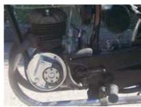
Lichtmagnetzündanlage mit integrierter vollelektronischer Zündung. Lichtleistung 12V/100W Gleichstrom.
