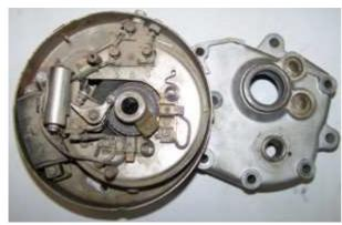
Lösen Sie nun alle Kabel an Ihrer alten Lima und entfernen Sie diese. Nehmen Sie die Passfeder auf dem Konus der Kurbelwelle mit einer Zange ab. Sie wird nicht mehr benötigt! Bitte nicht vergessen sonst müssen Sie die Lima später noch einmal herausnehmen.
