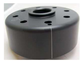
Sehen Sie sich den neuen Rotor an. Sie werden auf seinem Außenumfang eine kleine eingepresste strichförmige Markierung finden.
