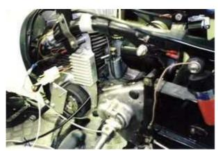
Befestigen sie den elektronischern Gleichrichter/Regler, das Relais und die elektronische Zündspule an einer geeigneten Stelle.
