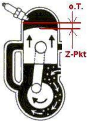
Entfernen Sie die Zündkerze. Stecken Sie den neuen Rotor handfest auf die Kurbelwelle um die Gelegenheit zu haben die Welle damit zu drehen. Bringen Sie den Kolben in die Stellung Zündzeitpunkt. Wir empfehlen diesen auf ca. 3,5mm vor Oberer Totpunkt zu stellen.
