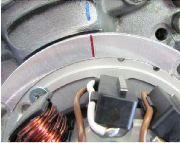
Da die Zündmarkierung nach Aufsetzen des Rotors von diesem verdeckt wird, ziehen Sie die Markierung einfach mit Faserstift auf den Motorblock wie hier gezeigt.
