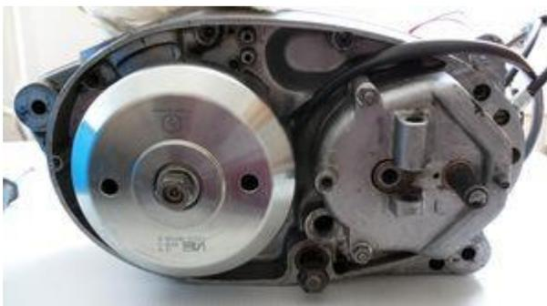
Die Zündung ist jetzt eingestellt. Bei Bedarf kann diese durch Abnehmen des Rotors und Aufsetzen im Winkel zu dieser Grundeinstellung theoretisch beliebig verändert werden.
