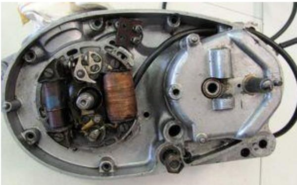
Lösen Sie nun alle Kabel an Ihrer alten Lima am Klemmbrett. Schneiden Sie die zur Lampe hochführenden Kabel aber nicht ab, Sie werden weiter verwendet.
