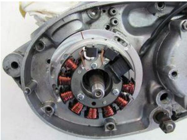
Setzen Sie die vormontierte Statorplatte so in das Motorgehäuse, dass die dicke schwarze Spule des neuen Stators auf etwa 02 Uhr zeigt.
