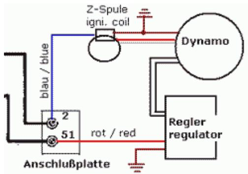
Die beiden früher zum Klemmbrett der Lima gehenden Kabel, die Sie zu Beginn von der alten Lima abgenommen, aber (hoffentlich) nicht abgeschnitten haben, werden an das neue System geklemmt. Sie stellen die Verbindung zwischen dem alten und dem neuen System dar.
