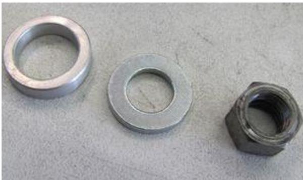
Legen Sie die Distanzbuchse und die Distanzscheibe auf und verschrauben Sie den Rotor mit der originalen Befestigungsmutter. Zum erneuten Lösen des Rotors verwenden Sie einen Abzieher M27x1,25.
