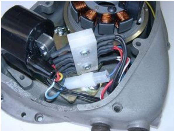
Ziehen Sie jetzt vorsichtig das Hochspannungskabel (Zündkabel) und den Kabelstrang mit den 6 Kabeln so weit aus dem Gehäuse das der Kabelverlauf im Motorgehäuse sauber ist und nicht am Rotor scheuern kann. Justieren Sie ggf. die Lage der Zündspulenplatte (Langlöcher) und ziehen Sie die beiden Schrauben fest. (Nicht vergessen!)
