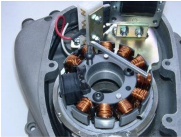
Setzen Sie den Spulenkörper wieder auf die Platte. Achten Sie darauf, keine Kabel darunter einzuklemmen, achten Sie zudem darauf dass der Arretierbund der Alu-Platte exakt im Innenring des Spulenkörpers zu sitzen kommt. Wenn der Spulenkörper verkantet sitzt, besteht die akute Gefahr einer Zerstörung durch Rotorkontakt. Verschrauben Sie den Spulenkörper wieder mit den 3 Innensechskantlinsenschrauben M6x30.
