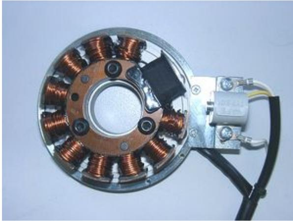
Die **neue Statoreinheit** ist vormontiert damit deren Aufbau leichter erkennbar ist. Für die Montage muss sie teilweise demontiert werden.
