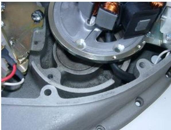
Setzen Sie die aus dem Stahlring, der Aluminiumplatte und dem Sensor bestehende Statorplatte anstelle der früheren Lichtmaschine in das Kurbelgehäuse. Der Sensor weist dabei nach unten, das Kabel geht (wenn man von vorn auf die Anlage sieht) links hoch zum Leitungsverbinder auf der Zündspulenplatte.
