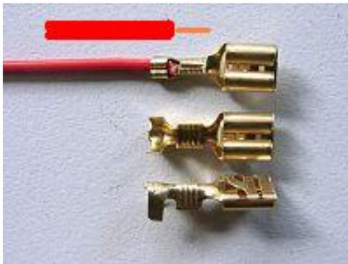
Sind die Kabel verlegt und wenn nötig entsprechend gekürzt, montieren Sie die Stecker an den Enden um die Kabel dann mit den Geräten zu verbinden. Das sind alles 6,3mm Steckbuchsen, die wir mitliefern und die dann nach dem Anklemmen am Kabel in Plastverbinder gesteckt werden. Klemmen Sie die Steckbuchsen sorgfältig an. Die Kabelisolierung muß am hinteren Ende der Steckbuchse festgeklemmt sein (Zugentlastung) und der abisolierte Teil des Kabels soll fest im vorderen verklemt sein.
