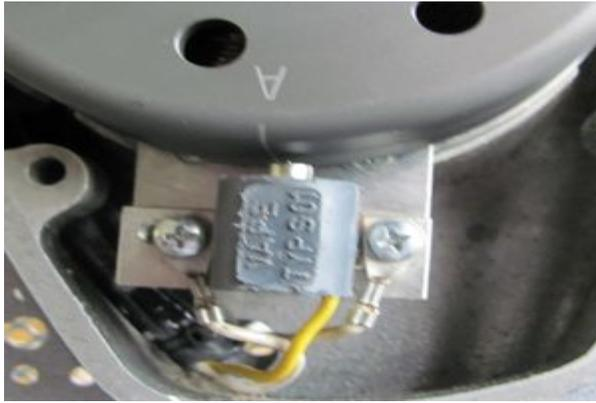
Bleibt das Aufsetzen des Rotors. Stecken Sie ihn zunächst lose auf und prüfen, ob er frei über der Grundplatte läuft. Lassen Sie den Rotor gleich aufgesetzt um ihn jetzt zum Drehen der Kurbelwelle zu nutzen, denn Sie müssen OT einstellen.
